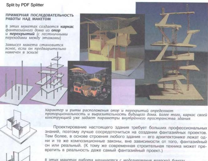
в этих макетах работа начинается с моделирования полоской бумаги внутреннего пространства первого этажа дома, а затем возводятся опоры и перекрытия для последующих этажей, к которым крепятся стены, замыкающие внутреннее пространство здания
