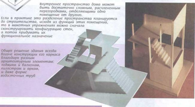
В макетах учащихся конструкция здания создается из композиционно уравновешенных вертикалей и горизонтальных плоскостей. Диапазон работ — от простейших макетов из опор и перекрытий до сложных макетов, где использованы различные архитектурные элементы (окна, своды, лестницы и др.)
